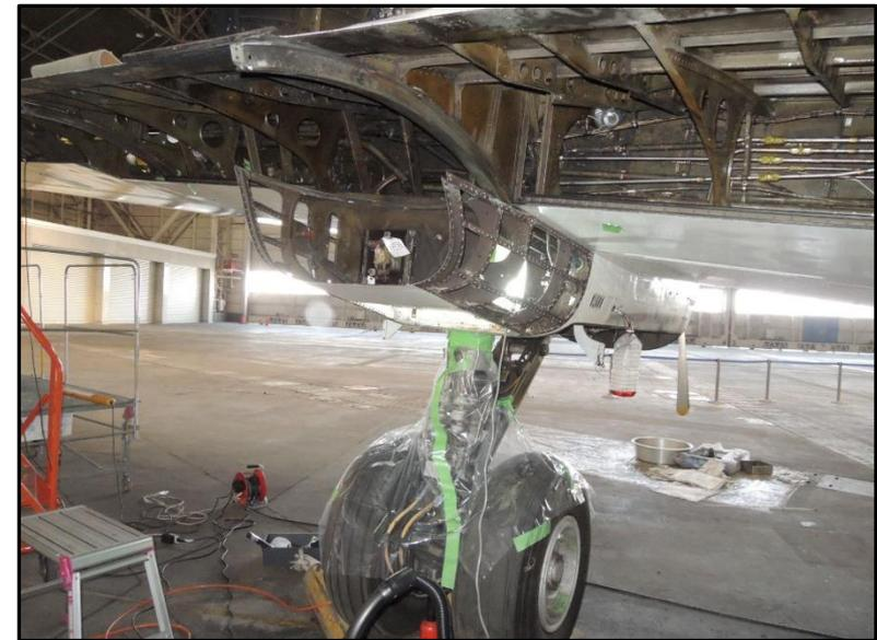
2019-11-01-主翼後縁取外しの為に外板を外したエンジンナセル後方下部
